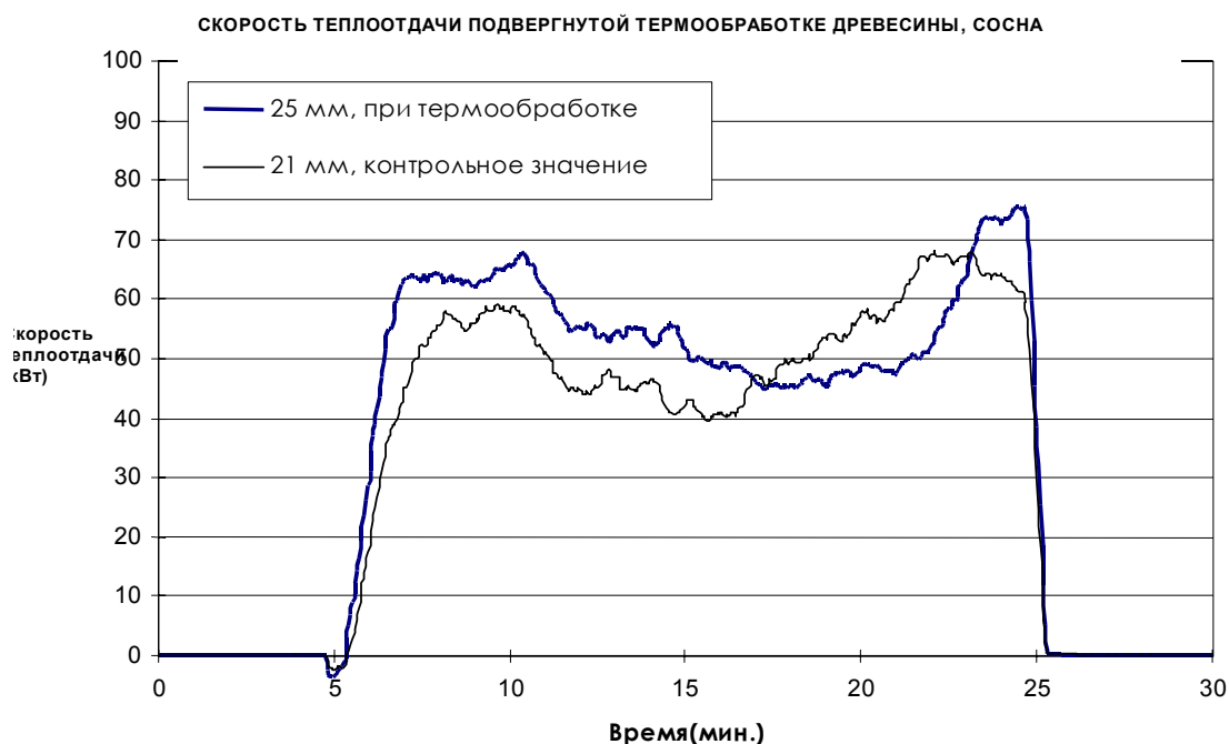
Рис. 11-4. Скорость теплоотдачи образцов сосны, подвергнутой термообработке (2/1), и необработанной (3/1). Толщина образца была 21 и 25 мм для необработанного и обработанного образца соответственно.
